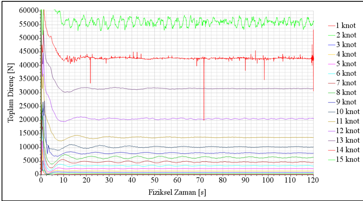
Şekil 6. HAD hesaplamalarında 120 saniye boyunca toplam direnç değişiminin fiziksel zamana bağlı grafiği (yarım model toplam direnç değerleri)
