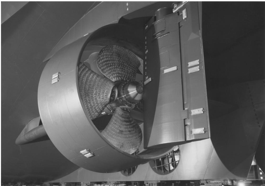
**Abbildung 1.8: Düsenpropeller. Spezialschiff Offshore-Industrie Anchor Handling Tug Supply Vessel (AHTS). Volkswerft Stralsund**
