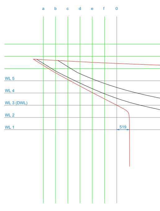
Şekil 5.9. Ana teknenin kıç bodoslamasına eklenen postalar
