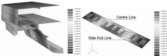
Figure 7A.- Shear Stress flow (MPa)
